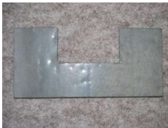
写真2、スレート製せき板
